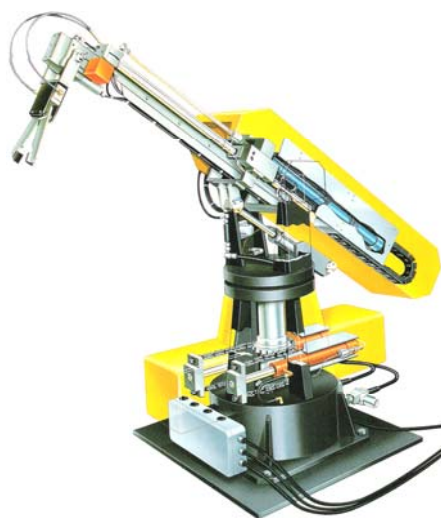
Slika 1: Primer: Na slici je prikazan industrijski robot. Pronađi element koji ostvaruje njegovo obrtanje oko vertikalne ose.
